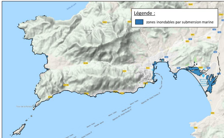
Figure 26 : Identification des zones inondables par submersion marine. Sources des données : TRI d'Ajaccio & portail Georisques. Carte réalisée par EcoAct.
