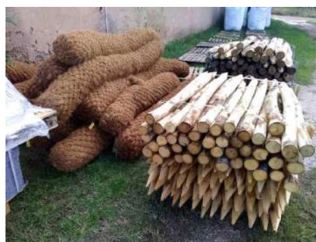
Pali di castagno e tubolari di fibre di cocco per le fascine
