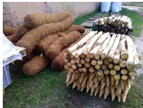
Pieux de châtaignier et boudins de fibres de coco pour les fascines
