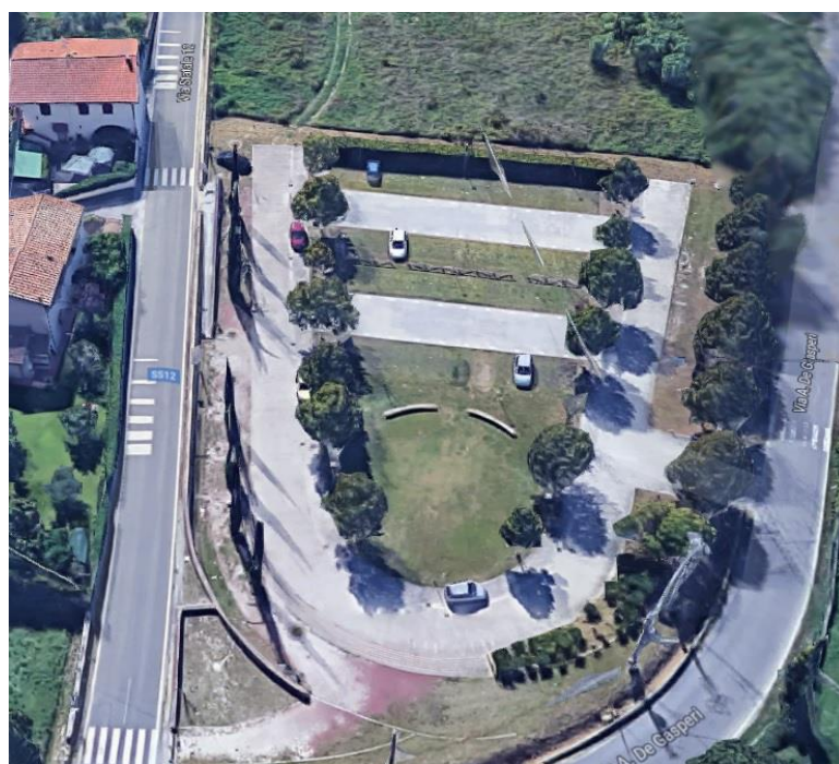
Ci-dessus : exemple d'un parking perméable pour préserver l'infiltration e protéger la valeur urbaine de la zone. San Giuliano Terme (Pisa), Toscana
