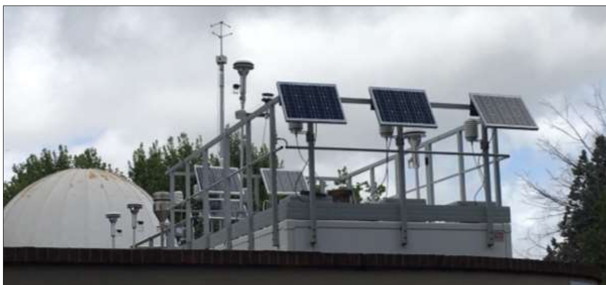
Figura 5.5.4.1. Intercomparaison des microcapteurs sur la station de référence de Marseille-Longchamps.
