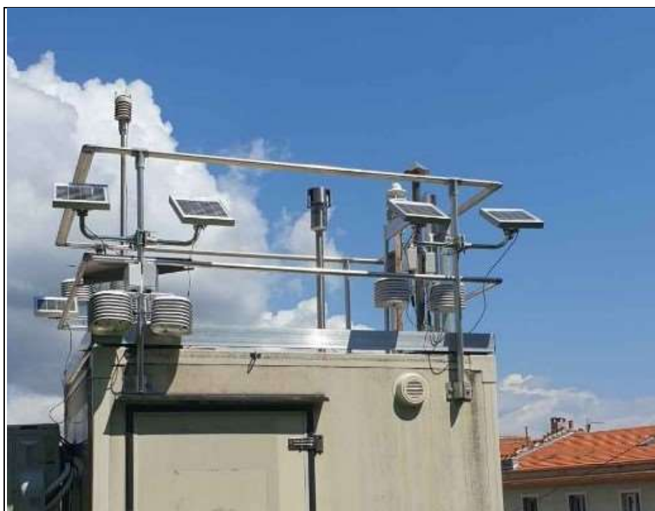
Figure 5.5.5.1. Calibration des capteurs \mu\text{NO}_2 avec station de référence.
