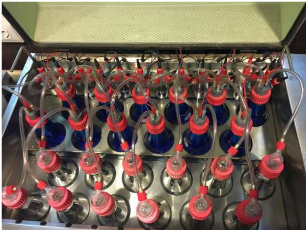
Figura 11. Configurazione dei reattori durante un test respirometrico
