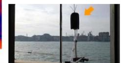
alla prima cortina edificata lungo il canale della Giudecca), impostando la centralina in modo da registrare tutti i principali parametri acustici ad intervalli di un secondo. Per l'analisi dei transiti è stata quindi utilizzata la storia temporale degli spettri lineari in terzi d'ottava.
