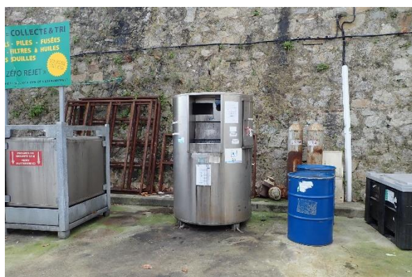
Raccoglitore per olio motore usato (grigio) e filtri dell'olio (contenitore blu)
