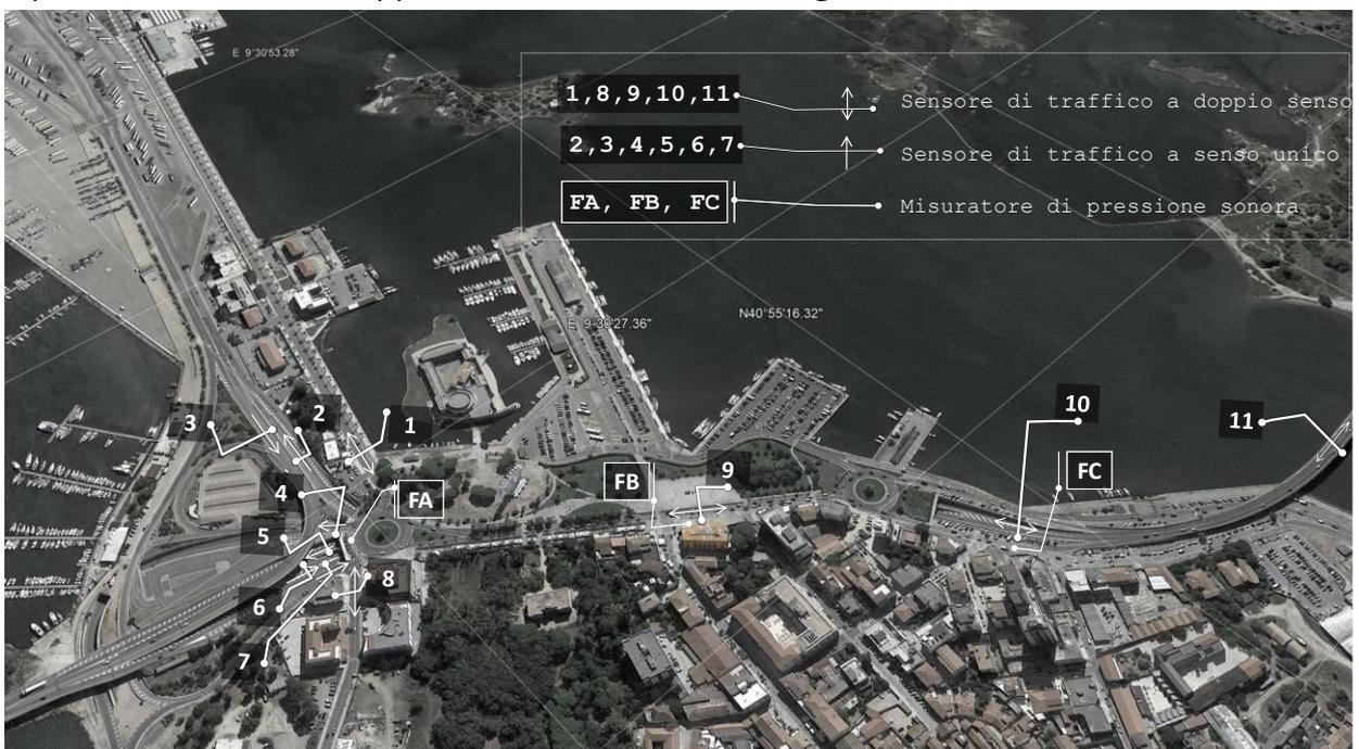
**FIGURA ERRORE.** NEL DOCUMENTO NON ESISTE TESTO DELLO STILE SPECIFICATO..**29: POSIZIONE DEI MISURATORI DEL LIVELLO DI PRESSIONE SONORA E DEI SENSORI DI TRAFFICO NELL'AREA URBANA DEL WATERFRONT DELLA CITTÀ PORTUALE DI OLBIA DURANTE LE CAMPAGNE SPERIMENTALI DEL 2019.**
