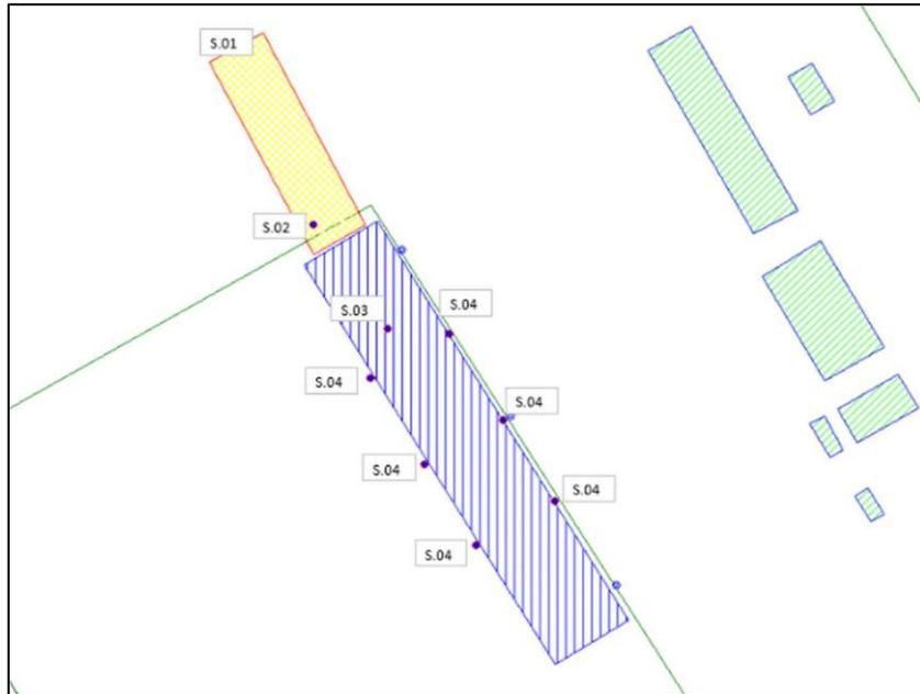
Figura 2.2: Le sorgenti del molo Sabauda all'interno del software SoundPLAN.
