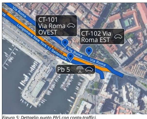
Figura 5: Dettaglio punto Pb5 con conta-traffici.
