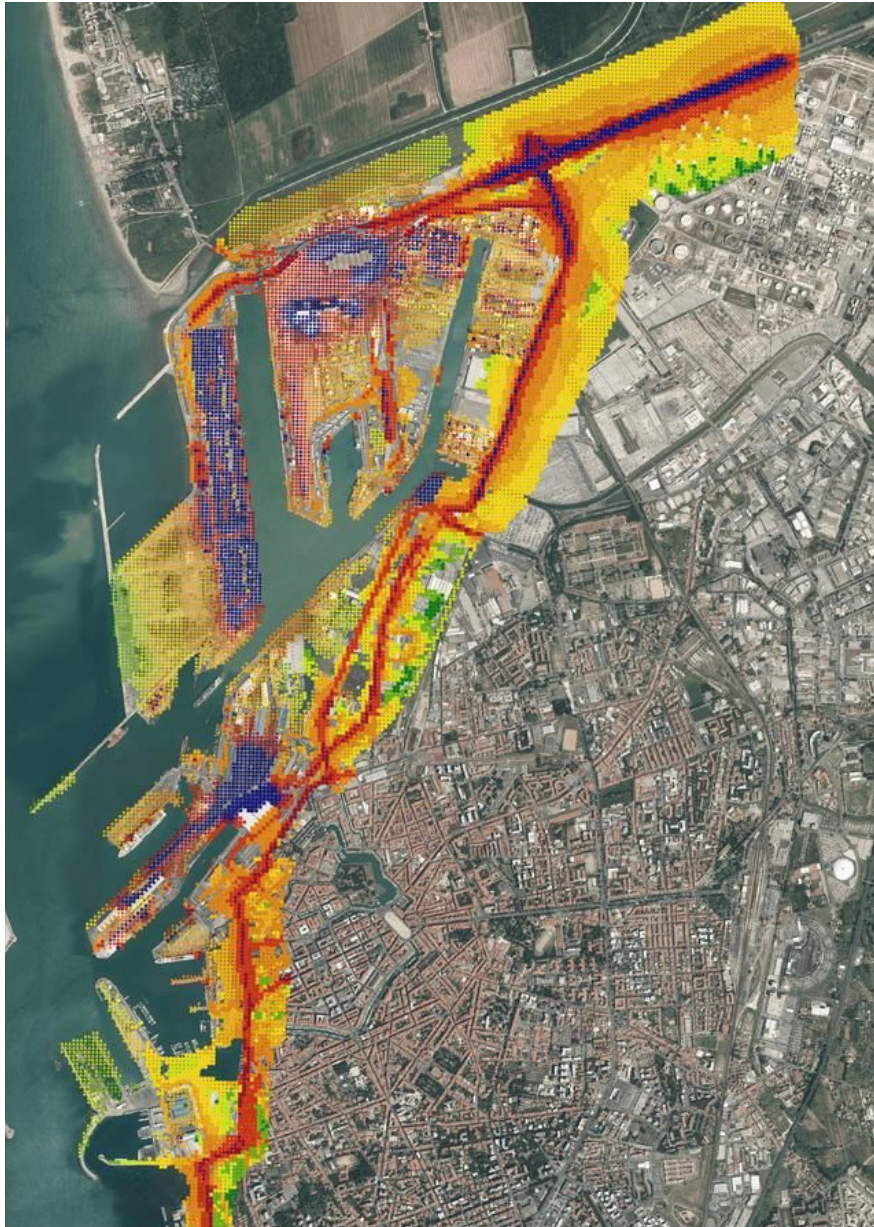
Figura 7: Mappa delle sorgenti predominanti secondo l'indicatore L_{DEN} e il metodo di calcolo CNOSSOS
