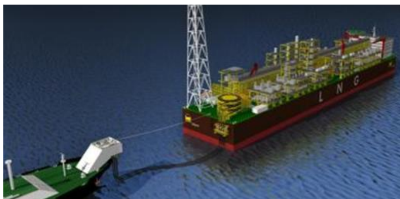
Figura 32. Trasferimento di GNL tramite tubi flessibili galleggianti
