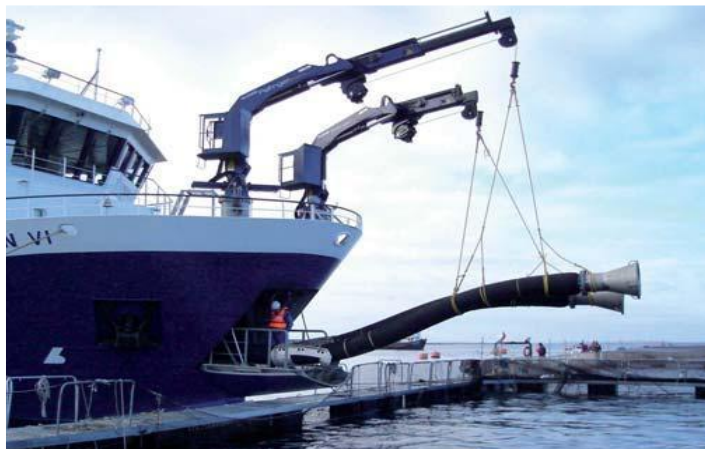
Figura 35. Movimentazione di tubi flessibili per bunkering di GNL mediante gru su ponte nave
