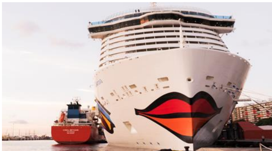
Figure 15. Opérations de soutage de GNL effectuées par AIDA Nova aux îles Canaries
