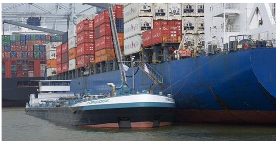
Figure 16. Configuration des STS par barge
