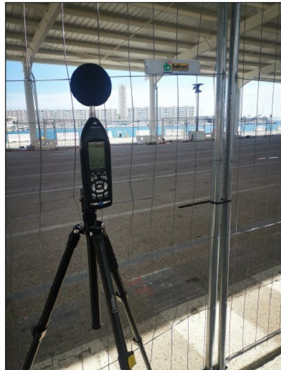
Figure 19 - Sonomètres pour l'étude des toiles d'ombrage
