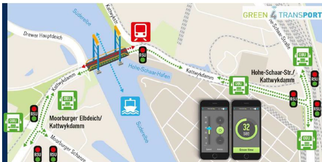
Figure 40 - Application du V2X dans le projet Green4Transport
