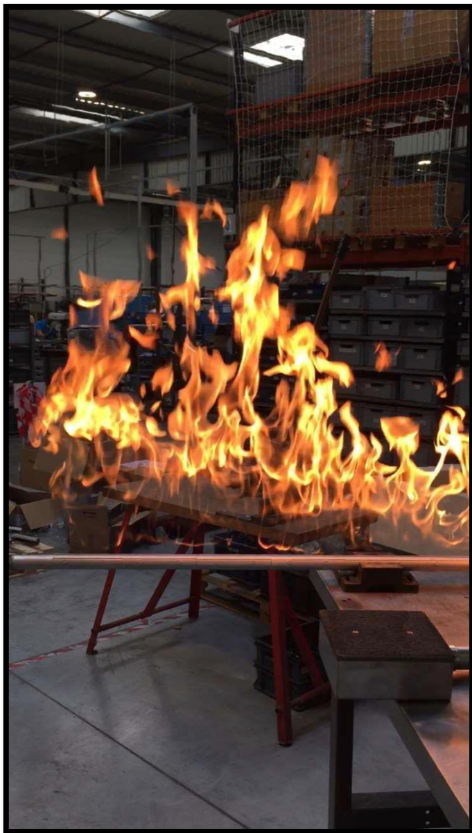
Foto10. Bruciatore a rampa
