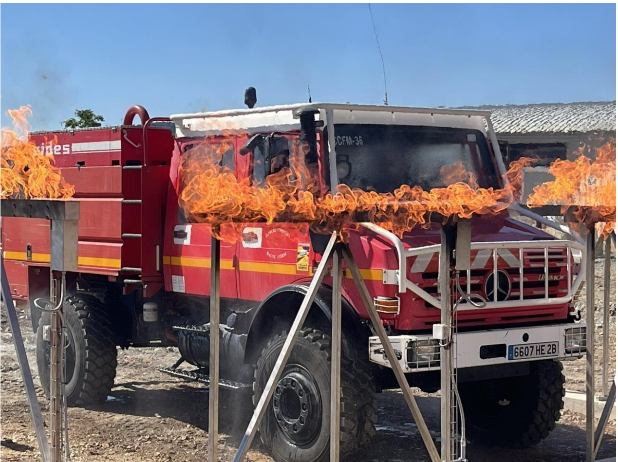
Foto18. Test bruciatore a rampa / autopompa forestale
