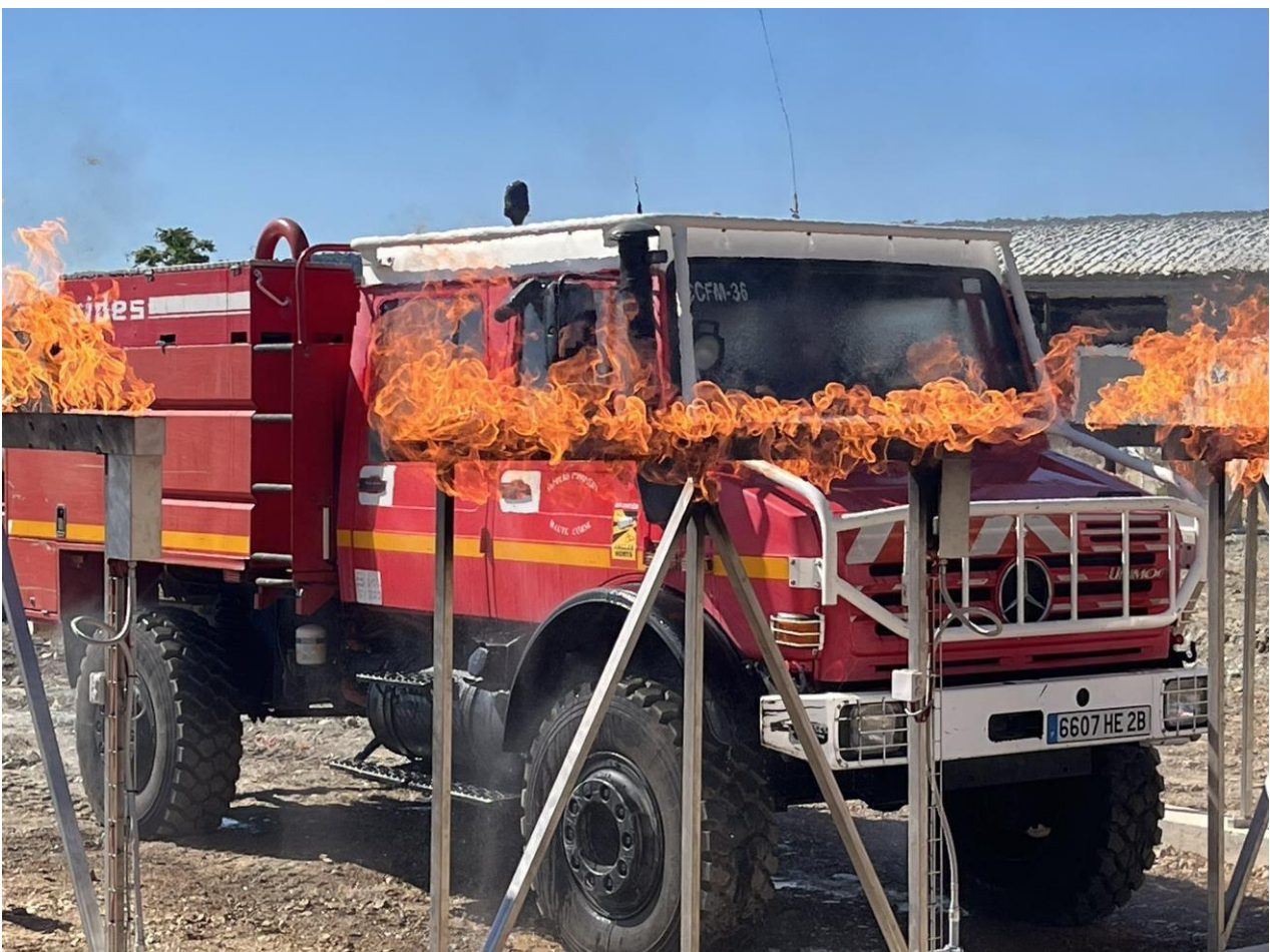
Fig.18. Test brûleurs rampe / camion
