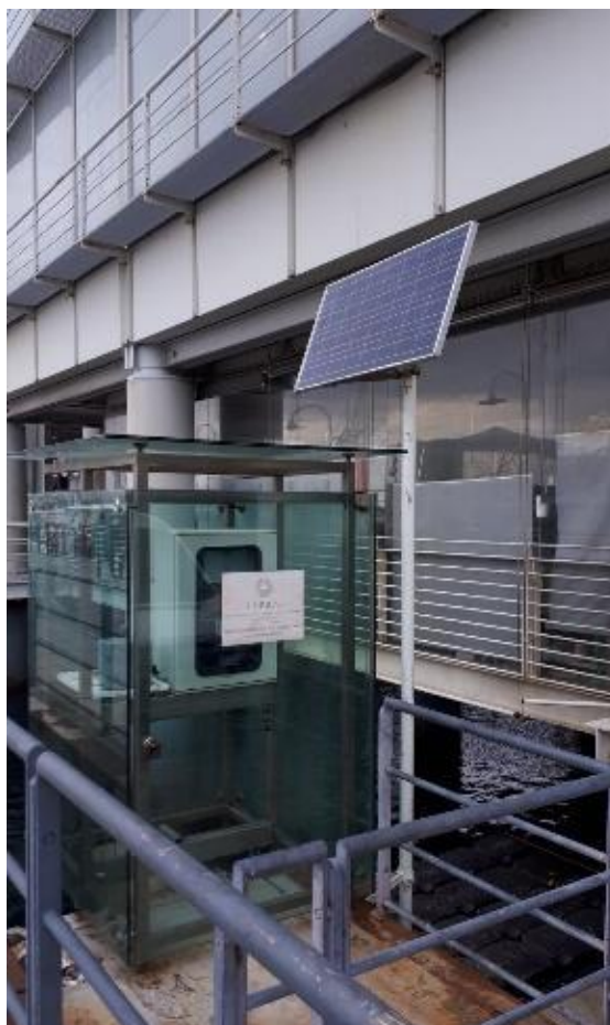
Figura 2. Stazione di misura del livello del mare per la località di Genova.
