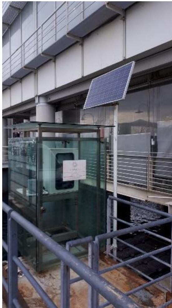
Figure 2. station de mesure du niveau de la mer pour la localité de Gênes.
