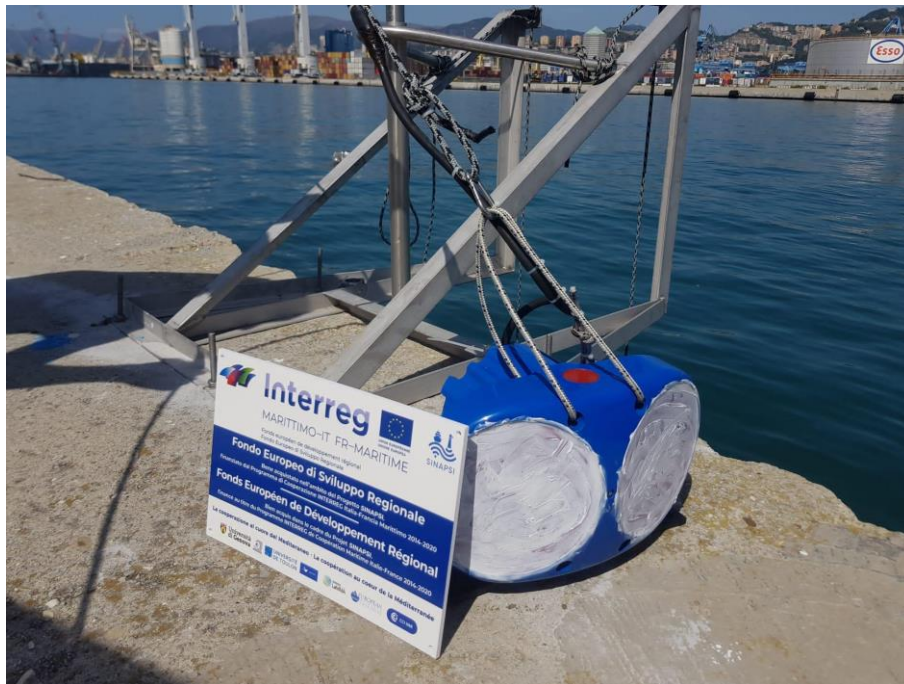
Correntometro Channel Master della stazione 3 presso Calata Bettolo.
