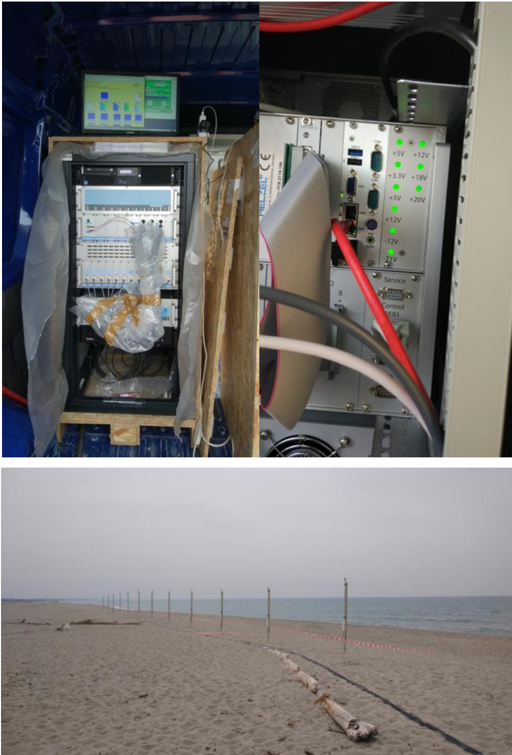
Fig. 2.3.4 - Photo de la configuration du système radar HF pendant les tests. En haut, l'unité émettrice-réceptrice placée dans la camionnette ; en bas, le groupe d'antennes de réception installé sur la plage.
