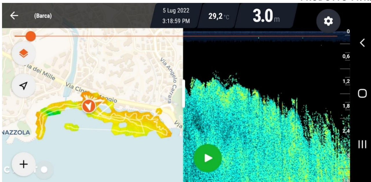
Fig. 2.1.6 - Schermata della app associata al dispositivo PRO+2. La parte sinistra dello schermo mostra i transetti campionati con il sonar; la parte destra dello schermo mostra la sezione trasversale del fondale nel punto indicato dalla freccia arancione nel pannello di sinistra dell'immagine.
