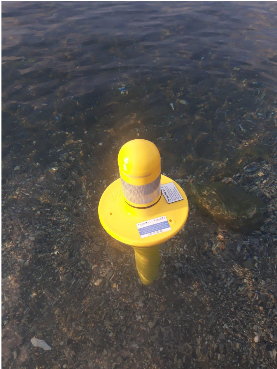
Fig. 2.1.9 - Drifter in opera durante la campagna di misura svolta in data 05/07/2022.
