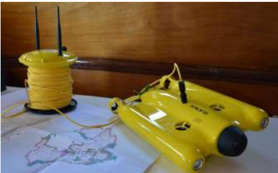
Figura 27 – Mini ROV utilizzato per i rilevamenti subacquei presso l'isola di Giannutri. (Foto S. Acunto)
