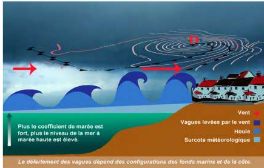
Figure C1 – Représentation schématique des différents processus engendrant le phénomène de submersion marine au passage d'une tempête
