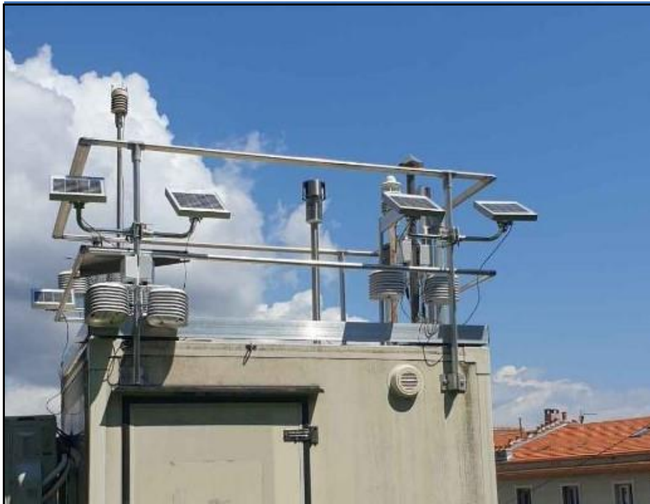
Figura 5.5.5.1. Taratura \mu\text{NO}_2 sensori con stazione di riferimento.
