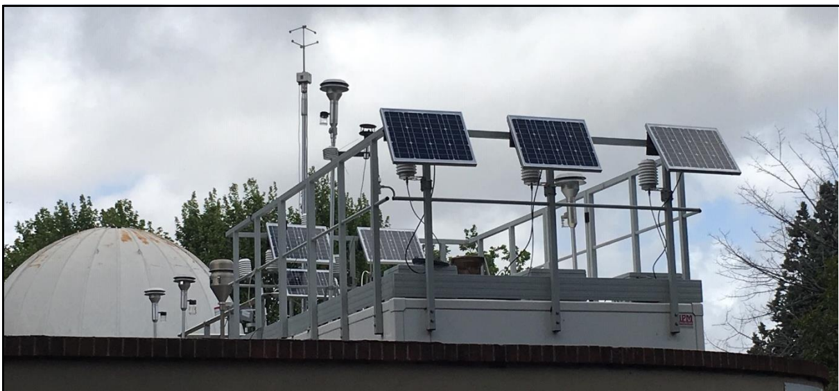
Figura 5.5.4.1. Intercomparazione dei microsensori alla stazione di riferimento di Marseille-Longchamps.
