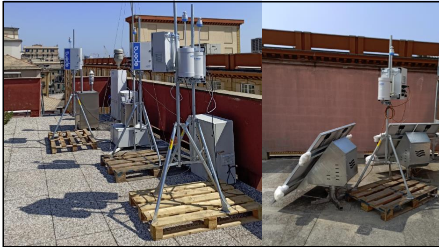
Figura 5.4.1.5. Sistemi smart e strumentazione convenzionale sulla terrazza sede ARPAL.
