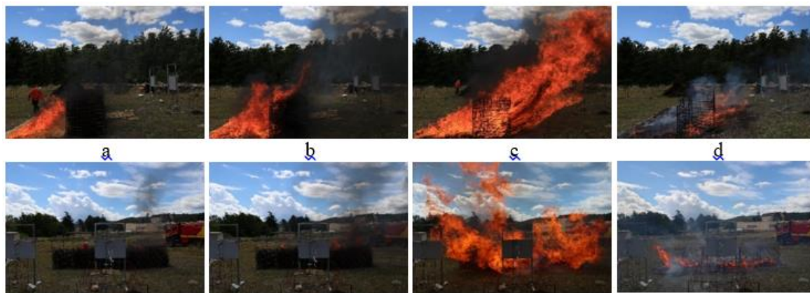
Figura 6 : Fotografie della combustione di una siepe alta 1 m (Test 1) a) Diffusione del fuoco nel riccio di legno (t = 1 s) b) Accensione della siepe (t = 5 s) c) Bruciatura della siepe (t = 19 s) d) Bruciatura delle particelle più spesse (t = 61 s).
