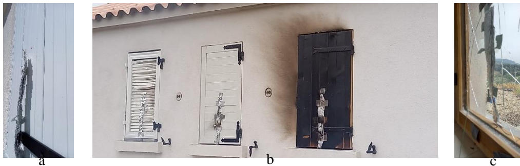
Figura 14 : Danni osservati con una siepe di a) 6\text{ m} \times 1\text{ m} \times 1\text{ m} - b e c) 6\text{ m} \times 2\text{ m} \times 1\text{ m}
