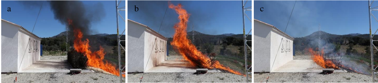
Figure 10 : Photographies des phases de combustion pour une haie de 6 m × 1 m × 1 m (Essai 8) a) Allumage de la haie par le front de flamme (t=1 s) b) Haie en combustion (t=17 s) c) Combustion des particules les plus épaisses (t=32 s)
