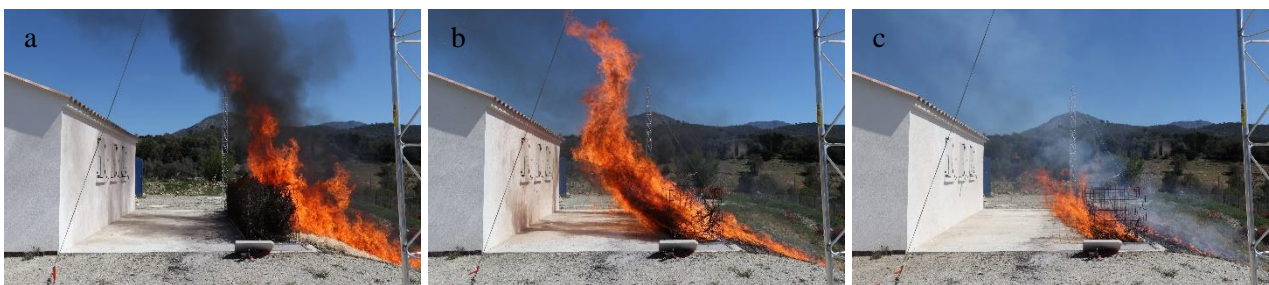
Figura 10 : Fotografie delle fasi di combustione di una siepe di 6 m × 1 m × 1 m (Prova 8) a) Accensione della siepe da parte del fronte di fiamma ( t=1 s) b) Bruciatura della siepe ( t=17 s) c) Combustione delle particelle più spesse ( t=32 s)
