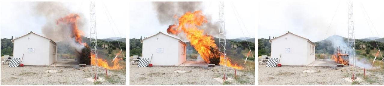
Figure 11 : Photographies des phases de combustion pour une haie de 6 m × 2 m × 1 m (Essai 13) a) Allumage de la haie par le front de flamme (t=2 s) b) Haie en combustion (t=14 s) c) Combustion des particules les plus épaisses (t=62 s)
