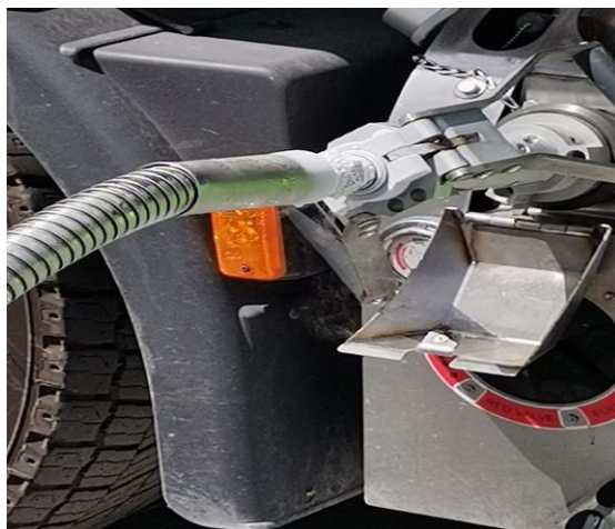
Messa a terra del mezzo e innesto erogatore.
