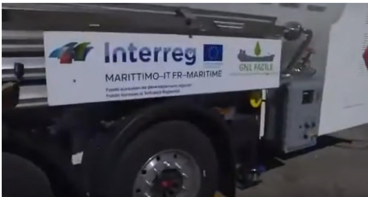
Fig. 1 : La station de remplissage mobile
