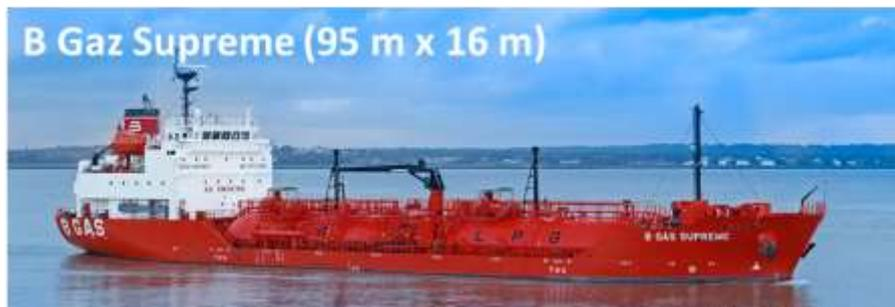
Questa nave battente bandiera maltese fornisce GPL alla Corsica per conto di Engie, Antargaz e Butagaz scaricando il gas in 4 stazioni dedicate. Può caricare 3500 m<sup>3</sup> di GPL, l'equivalente di 2100 T.
