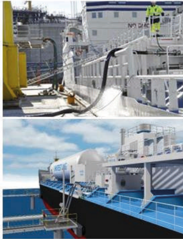
Image 7 : Approvisionnement en GNL selon la configuration PTS (Source : https://www.unitest.pl/?p=3131 ; https://www.manntek.se/lng/applications/ship-to-shore )
