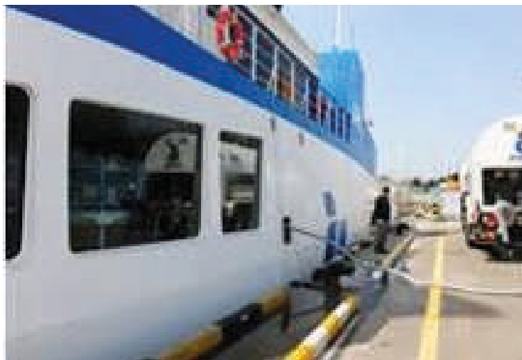
Immagine 5: Rifornimento di GNL secondo configurazione TTS (Fonte: http://www.donga.com/news/article/all/20190921/97506677/1 )
