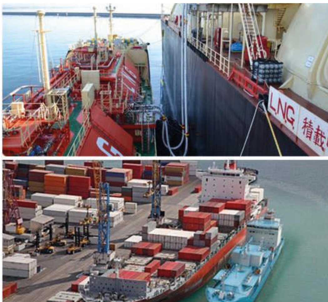
Immagine 6: Rifornimento di GNL secondo configurazione STS
