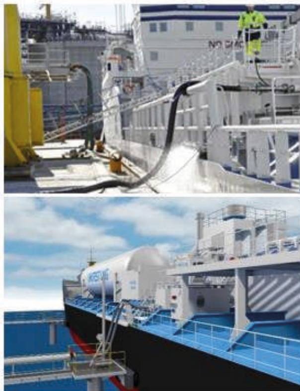
Immagine 7: Rifornimento di GNL secondo configurazione PTS (Fonte: https://www.unitest.pl/?p=3131 ; https://www.manntek.se/Ing/applications/ship-to-shore )
