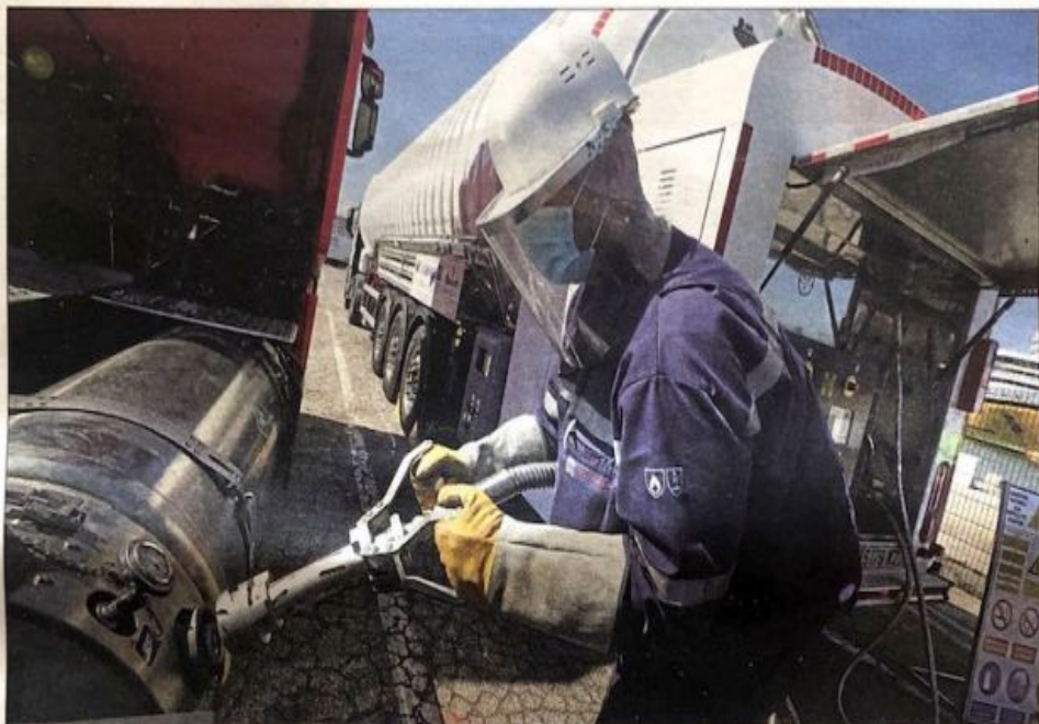
L'opérateur qui assure le plein en GNL doit s'équiper d'un casque et surtout de gants pour manipuler la tuyauterie qui conduit le gaz car celui-ci est à -160 ° !
