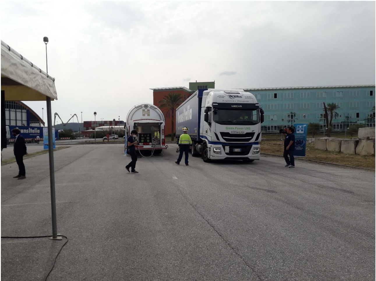
Figura 1, momento del rifornimento di autoarticolato con GNL (stazione di rifornimento mobile GNL sulla sinistra)
