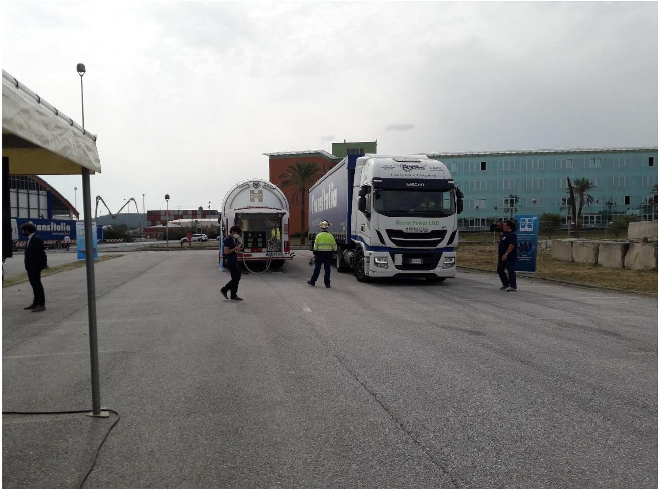
**Figure 1, moment du ravitaillement d'un camion articulé en GNL (station mobile de ravitaillement en GNL à gauche), qui a eu lieu sur une aire de stationnement de l'Interporto Toscano Amerigo Vespucci à Guasticce, (LI).**
