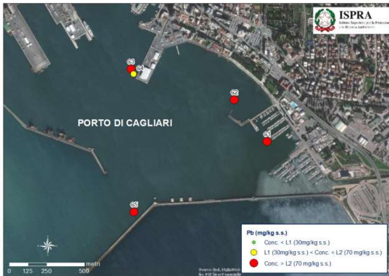
Carta 5 – Concentrazioni di piombo (mg/kg s.s.) rilevate nei campioni di sedimento prelevati nel porto di Cagliari. I valori sono confrontati con i Livelli Chimici di riferimento (L1 e L2) di cui alla Tabella 2.5 del D.M. 173/2016.
