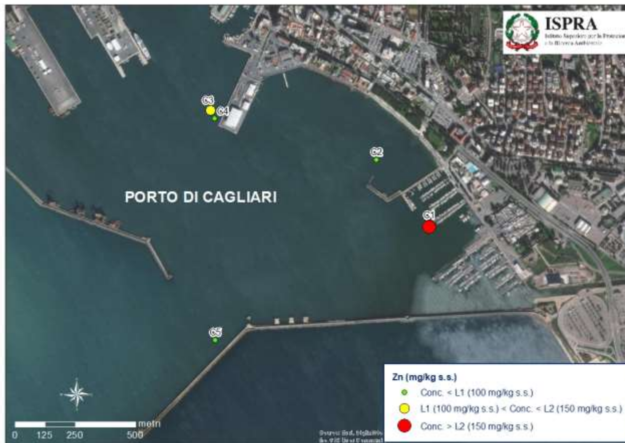
Carta 4- Concentrazioni di zinco (mg/kg s.s.) rilevate nei campioni di sedimento prelevati nel porto di Cagliari. I valori sono confrontati con i Livelli Chimici di riferimento (L1 e L2) di cui alla Tabella 2.5 del D.M. 173/2016.
