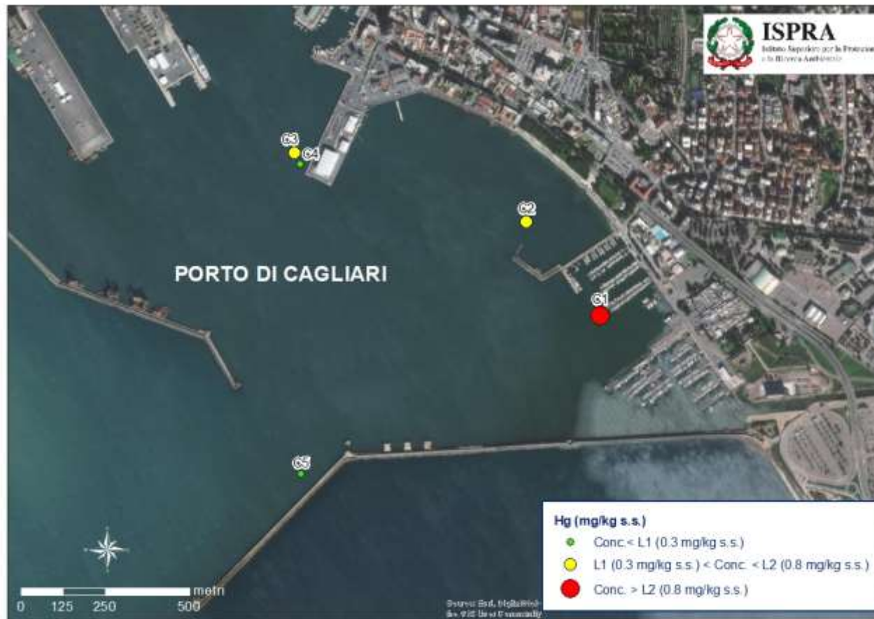
Carta 3 – Concentrazioni di mercurio (mg/kg s.s.) rilevate nei campioni di sedimento prelevati nel porto di Cagliari. I valori sono confrontati con i Livelli Chimici di riferimento (L1 e L2) di cui alla Tabella 2.5 del D.M. 173/2016.
