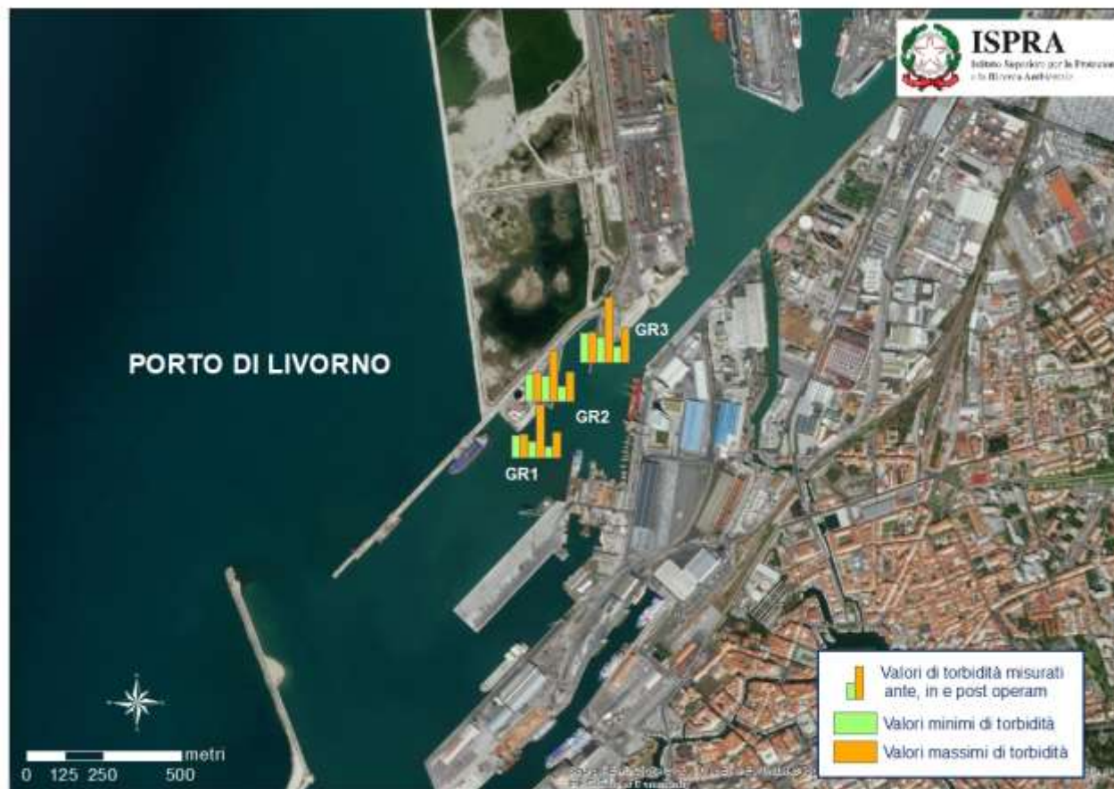
Carta 1 - Torbidità (FTU) riscontrata nelle fasi pre, durante e post intervento di dragaggio di sedimenti condotto nel porto di Livorno da ottobre 2020 a gennaio 2021. Per ciascuna stazione di monitoraggio sono riportati i valori minimo e massimo rilevati nelle tre fasi di campionamento.
