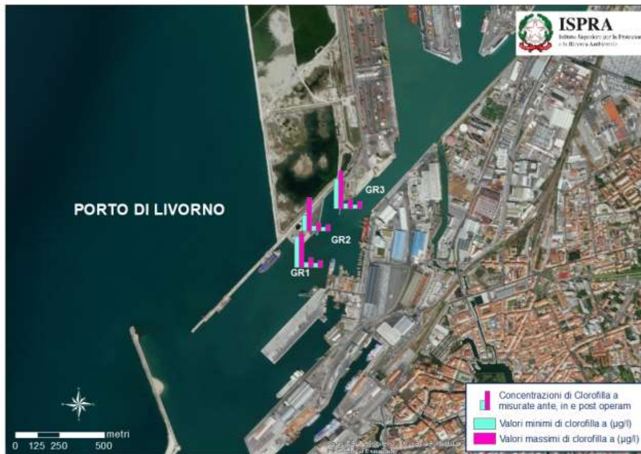
Carta 2- Concentrazioni della clorofilla ( \mu\text{g/l} ) riscontrata nelle fasi pre, durante e post intervento di dragaggio di sedimenti condotto nel porto di Livorno da ottobre 2020 a gennaio 2021. Per ciascuna stazione di monitoraggio sono riportati i valori minimo e massimo rilevati nelle tre fasi di campionamento.
