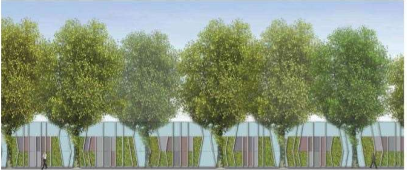
Protection antifonica je traite avec du panelli en verre stratifie panelli metallici microforaci et panelli equipe pour vert vertical
