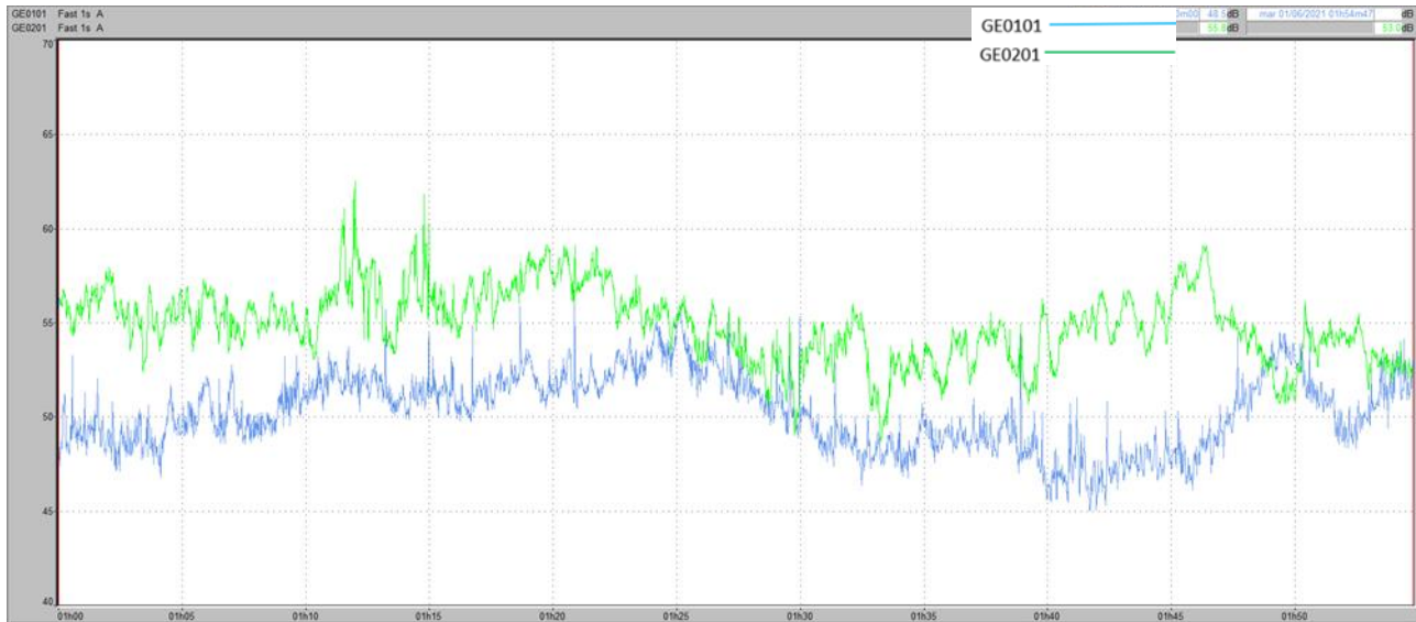
Figure 38. Comparaison des tendances temporelles des niveaux LAeq,1s avec trois navires à quai
