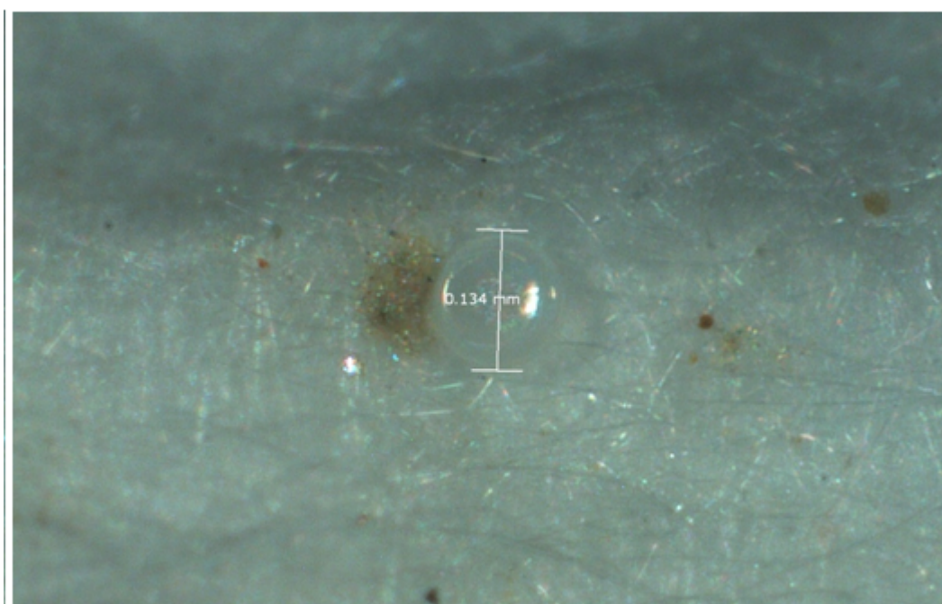
Esempio di pellet a disco trasparente misurato e fotografato al microscopio. Exemple de pastilles de disque transparent mesurées et photographiées au microscope.
