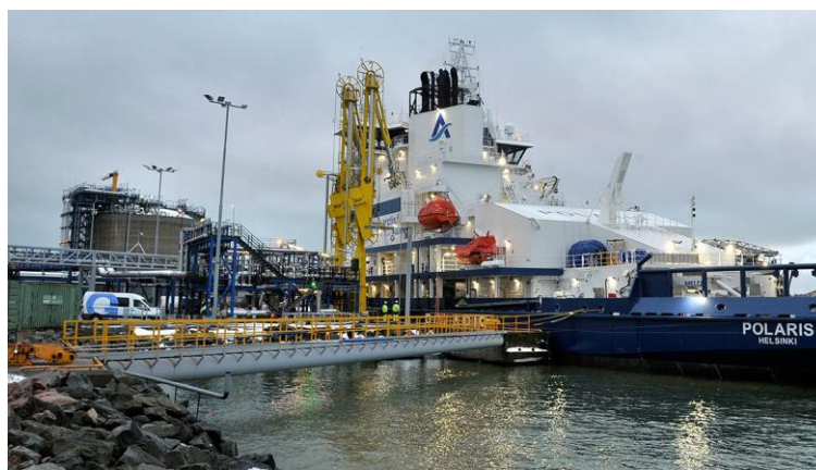
Figure 14 : Photo du soutage du brise-glace Polaris à partir du terminal méthanier de Pori
