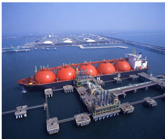
Figure 37 : Photo d'un méthanier avec réservoir de type B sphérique
