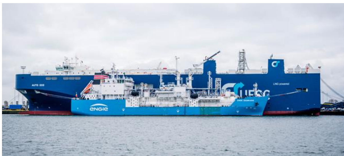
Figure 10 : Photo du navire de soutage GNL ENGIE Zeebrugge lors du soutage du navire de transport de véhicules M/V Auto Eco
