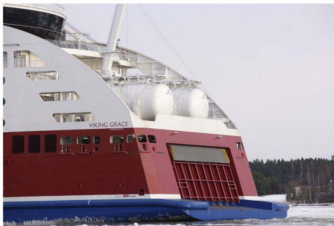
Figure 38 : Photo des deux réservoirs de GNL (200m 3 ) type C du ferry Viking Grace
