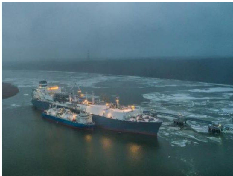
Figure 17 : Photo du navire avitailleur KAIROS (à gauche) lors d'une opération de rechargement de GNL à partir du FSRU Independence
