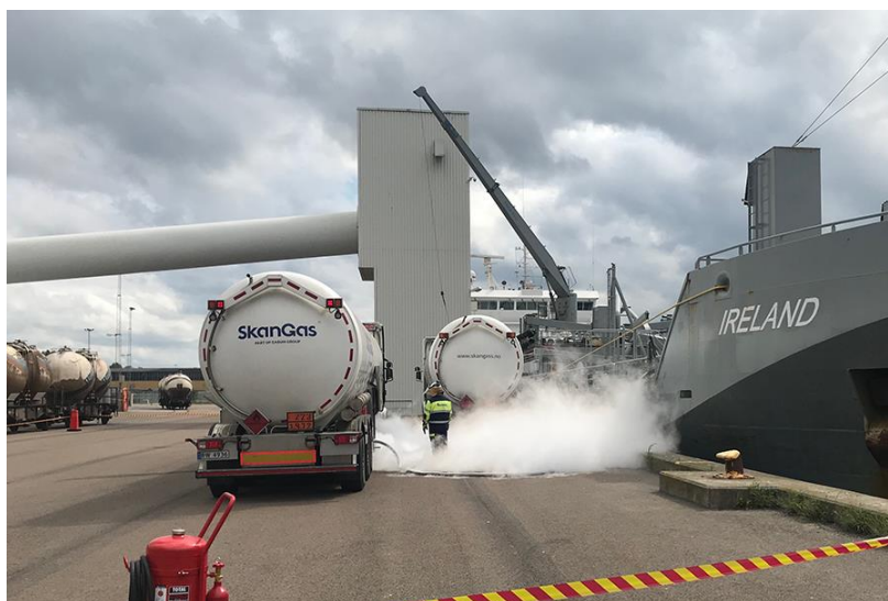
Figure 4 : Photo du soutage par camion-citerne GNL du cimentier Ireland
