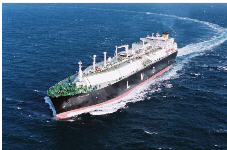
Figure 39 : Photo d'un méthanier avec réservoir membrane
