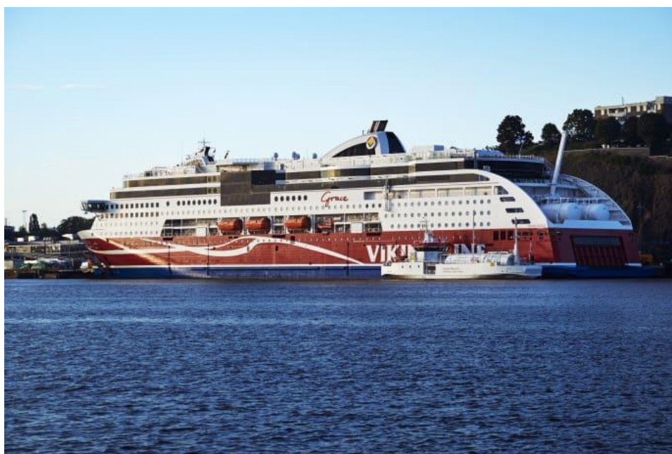
Figure 8 : Photo de la barge Seagas lors du soutage du M/S Viking Grace dans le port de Stockholm
