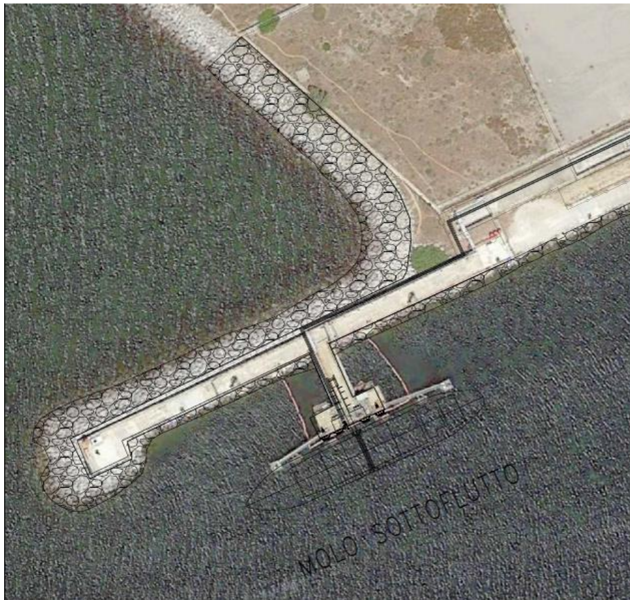
Figure11: Schéma de la jetée d'attraction et de chargement et déchargement
