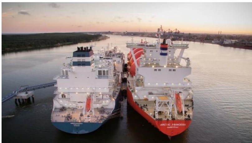
Figure 16 : Photo du FSRU Independence (à gauche) lors d'une opération de transfert de GNL à partir d'un méthanier
