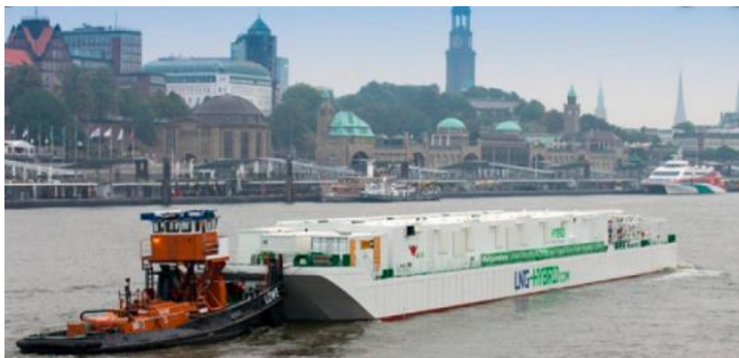
Figure 28 : Barge GNL d'alimentation électrique à Hambourg
